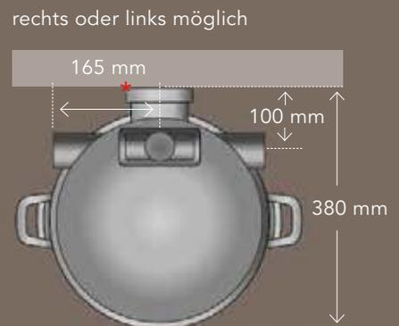
Bitte achten Sie darauf, dass alle Zentralstaubsauger mit einem Mindestabstand von 30 cm montiert werden (seitlich, oben und unten).
